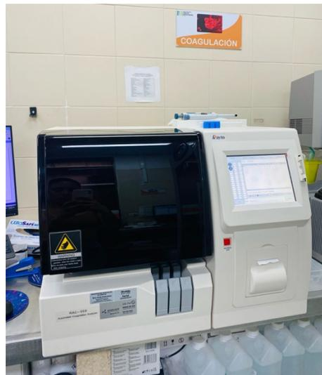
El Analizador de Coagulación se utiliza para el análisis de las funciones de coagulación y anticoagulación, fibrinolítica y antifibrinolítica en muestras de suero y plasma. Tiene una serie de funciones de análisis totalmente automatizadas, tales como el procesamiento de muestras mediante la dispensación de muestras y
